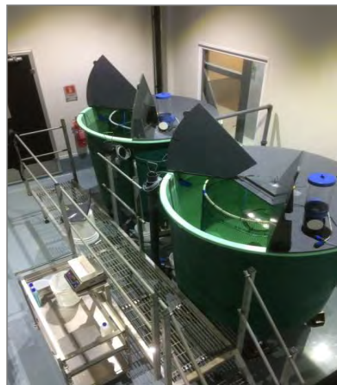
Figura 9. Vista de ambos estanques del estudio en zona de Hatchery. Se observa el cilindro confeccionado, formando el corredor de nado y circunscribiendo a la zona muerta, evitando de esta forma el acceso de los peces a esta zona.
